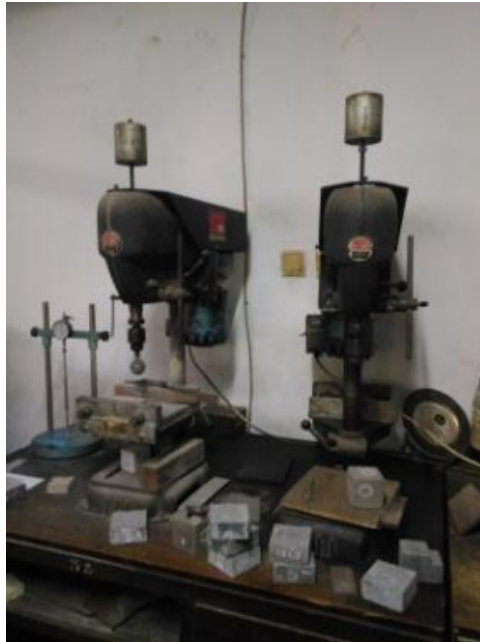
Gambar 8. Mesin Uji Aus Soiltest (Sumber: Lab. Bahan Bangunan FT Dep. Teknik Sipil dan Lingkungan UGM).
