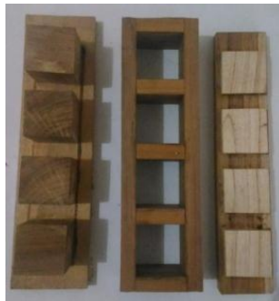
Gambar 9. Alat Cetak Oplosan Ukuran 5 cm x 5 cm x 5 cm Mortar Dipakai Untuk Uji Kuat Tekan dan Gesek
