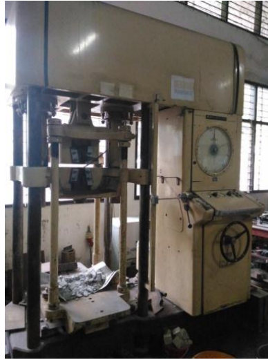
Gambar 7. Mesin Uji Tekan UTM Every-Denison (Sumber: Lab. Bahan Bangunan FT Dep. Teknik Sipil dan Lingkungan UGM).
