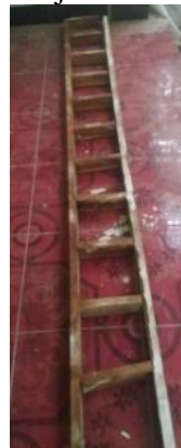
Gambar 10. Alat Cetak Oplosan ukuran 20 cm x 20 cm x 5 cm Mortar Dipakai Untuk Uji Ukir
